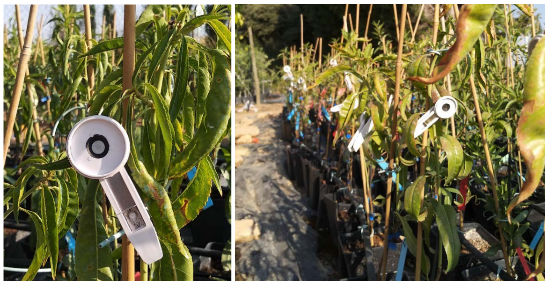
Figura 8. A la izquierda: detalle de clip de hoja durante la fase de adaptación a la oscuridad. A la derecha: disposición de varios clips sobre tratamiento testigo. Fuente: elaboración propia.
