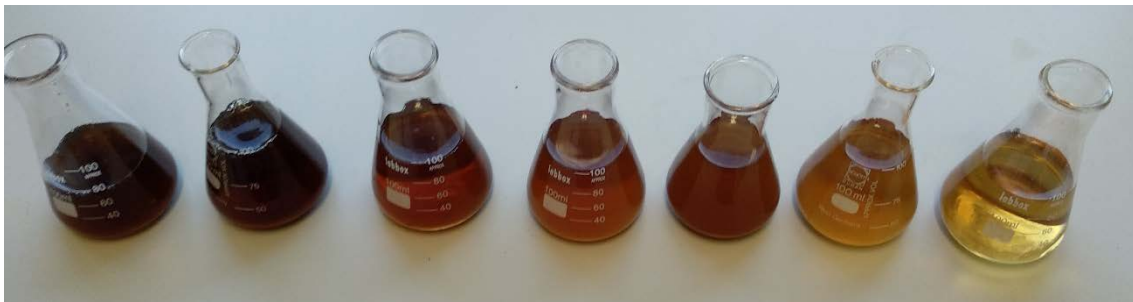
Figura 10. Resultado de la filtración. De menor a mayor concentración de caliza activa (izquierda a derecha). Fuente: elaboración propia.
