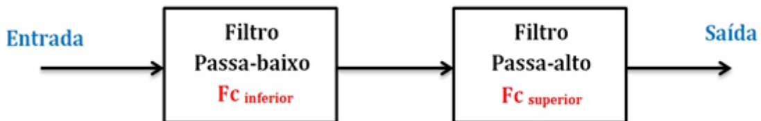
Figura 3.3.-Representação do digrama de blocos do filtro rejeita banda.
