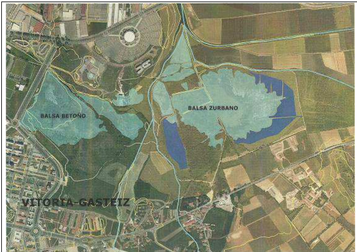
Figura 53: Propuesta de ampliación de la balsa de Zurbano. En verde, la actual balsa, y en azul, las zonas que se proponen como rebosadero. (Elaboración propia)
