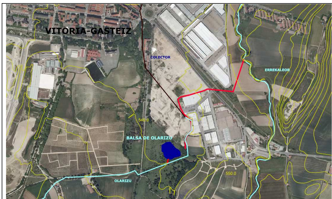
Figura 59: Esquema de las actuaciones en Olarizu: balsa y derivación al Errekaleor. (Elaboración propia)
