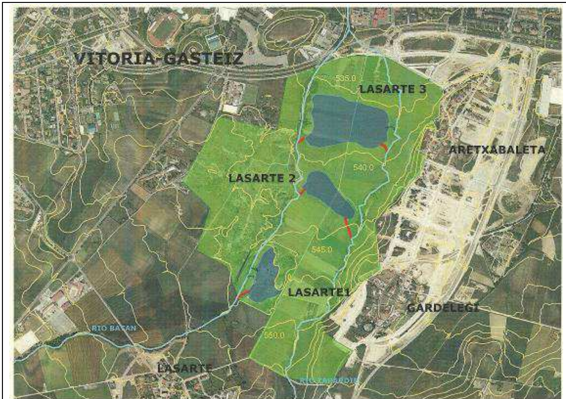
Figura 56: Propuesta para las lagunas de Lasarte. En rojo las conexiones de los ríos a las balsas. (Elaboración propia)
