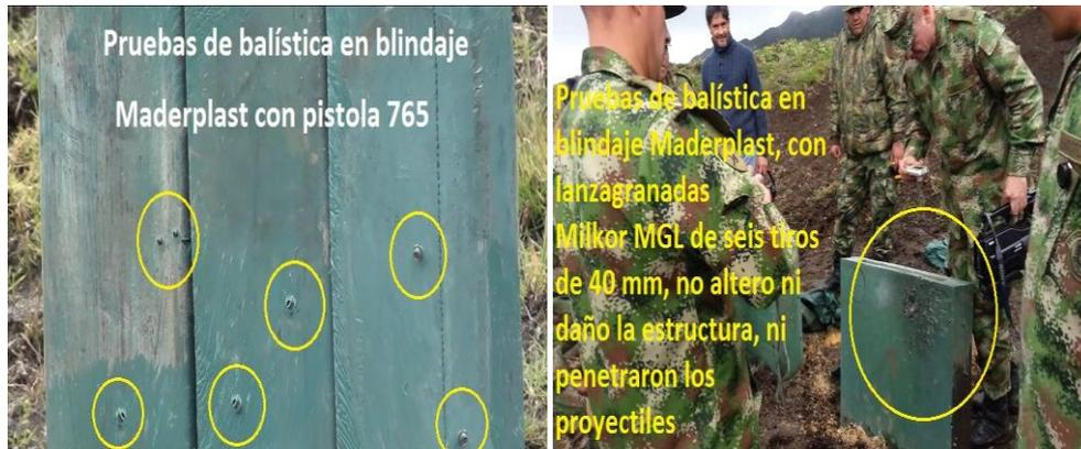
Figura 6. Imágenes de pruebas balísticas realizadas sobre maderplast
