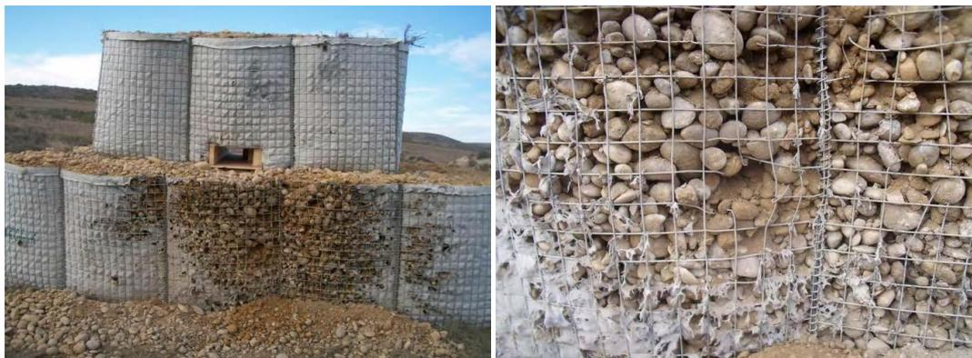
Figura 14. Impacto c-90 sobre estructura a doble altura de HESCO bastion
