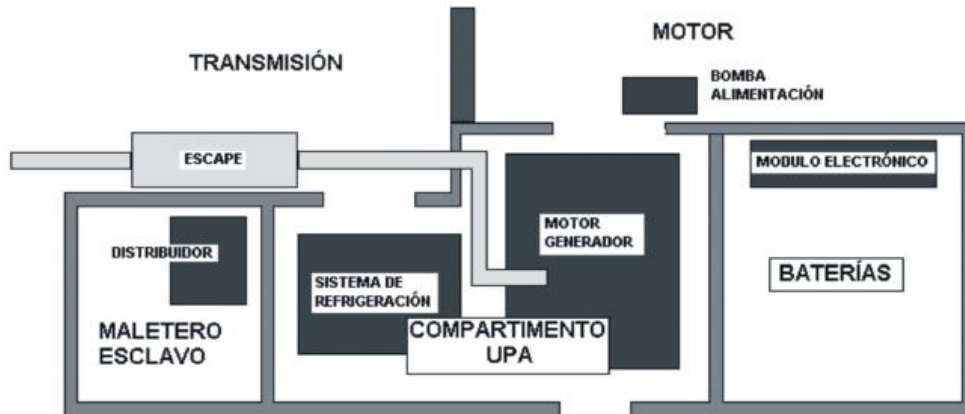
Figura 10. Esquema de los componentes de la UPA [12].
