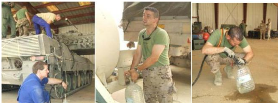
Extracción del líquido refrigerante de su depósito durante las pruebas en Sharorah.
