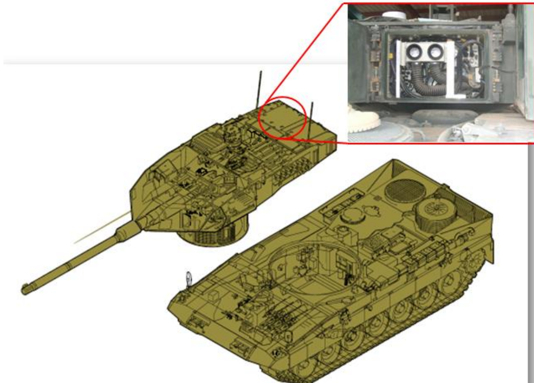
Figura 9. Lugar del Leopard 2E en el que fue instalado el sistema prototipo de aire acondicionado de KMW durante las pruebas realizadas en el desierto de Arabia Saudí [3] [4].
