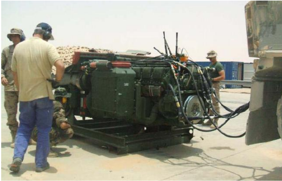
Cambio del GMP por mal funcionamiento de los ventiladores durante las pruebas del Leopard en Arabia Saudí en 2011.
