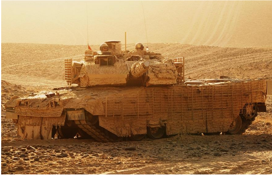
Figura 14. Se puede observar el perfecto mimetizaje que aporta el Sistema Barracuda así como el total recubrimiento del Leopardo [5].
