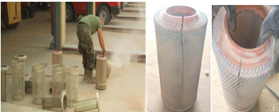
Limpieza de filtros durante las pruebas en Arabia Saudí. La gran acumulación de arena y polvo hizo que algunos se rompieran y hubiera que cambiarlos mucho antes de lo normal.
