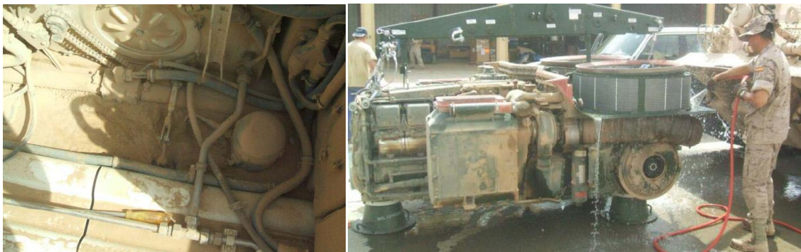
Acumulación de arena en la cámara del motor y posterior limpieza del GMP.
