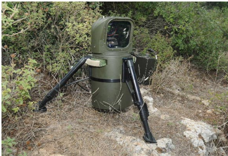
Figura O.2 Sensor de captura de imagen del sistema Pearls of Wisdom. Extraído de Defense Update
