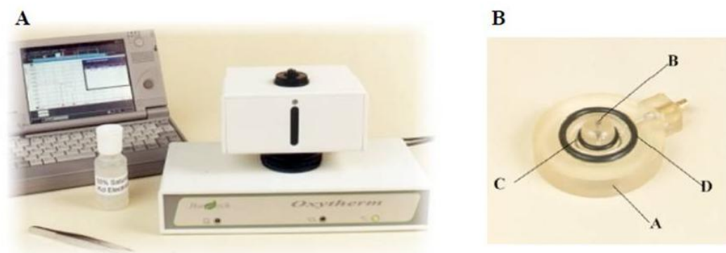
Figura 1. Oxytherm. A) Electrodo de oxígeno tipo Clark termostatzado (Oxytherm, Hansatech Instruments). B) Partes del electrodo (A) Disco de resina epoxy, (B) cátodo de platino en el centro de un saliente, (C) ánodo de plata en forma circular, (D) anillo de goma que sostiene el papel espaciador empapado en el electrolito y la membrana de teflón que separa los electrodos de la mezcla de reacción.
