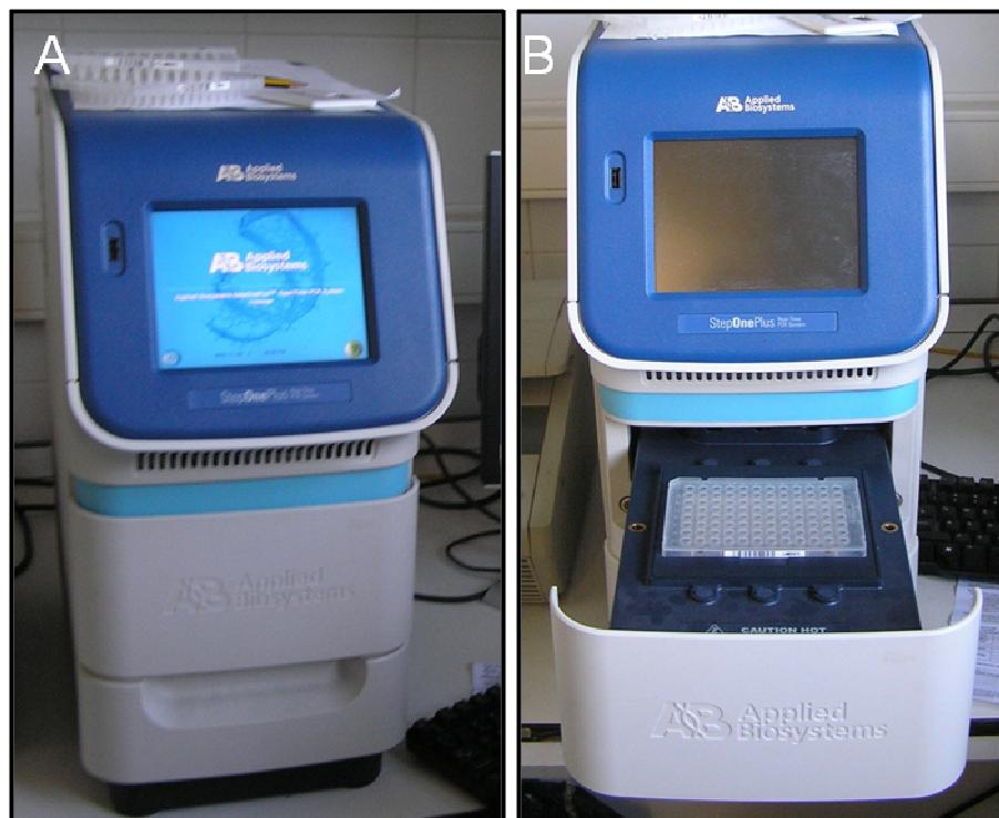
**Figura 29.** A) Termociclador serie GeneAmp que incorpora un lector de fluorescencia. B) Placa P96 colocada para su lectura.
