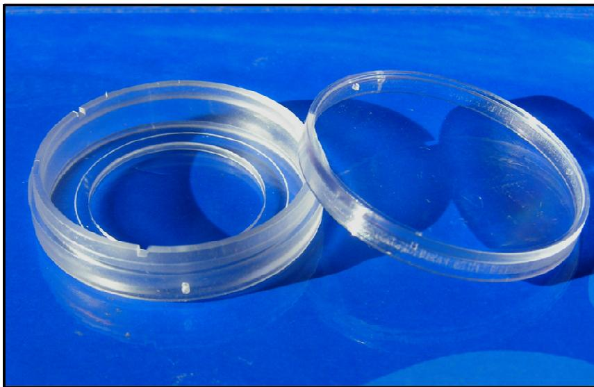
**Figura 24.** Placa de cultivo Ibidi para análisis de células vivas, de 35 mm y perfil bajo.
