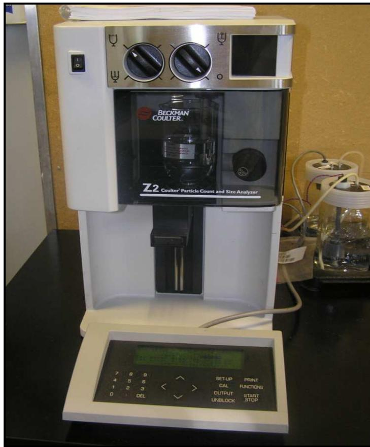
**Figura 11.** Contador celular automático Cell Coulter en funcionamiento. En la pequeña pantalla superior se puede observar el paso de las células. En la pantalla inferior aparece el número de células contadas.
