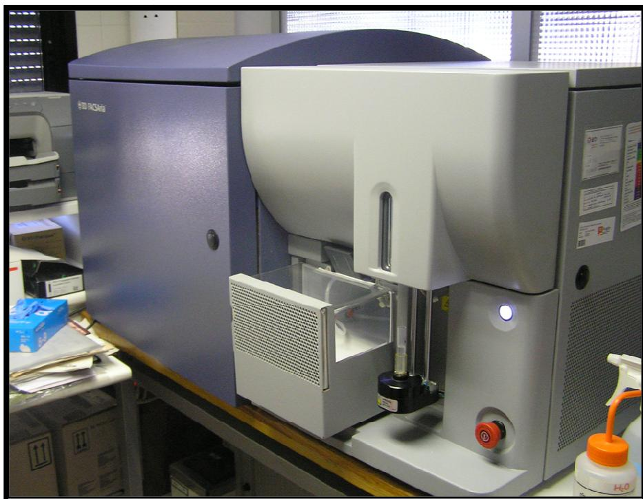
**Figura 25.** Citómetro separador celular FACS Aria. Es digital y con una capacidad de adquisición de muestras de hasta 70.000 eventos por segundo. Posee láseres en estado sólido de 407, 488 y 633 nm. Y un novedoso sistema óptico en octógono.
