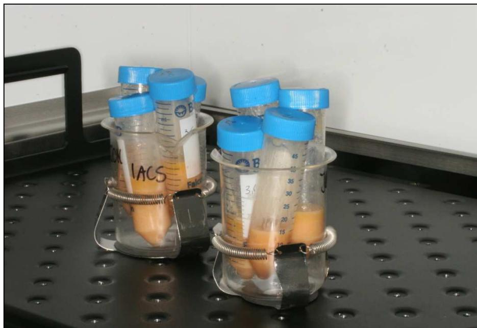
**Figura 8.** Digestión enzimática de la grasa en el incubador orbital.
