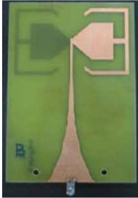
Figura 4.3: Prototipo de la antena construida.
