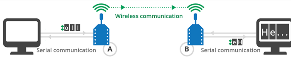
Figura 15: Esquema de comunicación con antenas XBee
