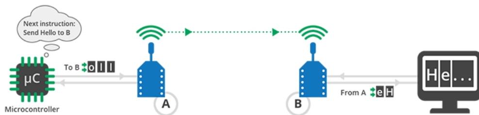
Figura 20: Comunicación XBee con puerto serie en modo transparente
