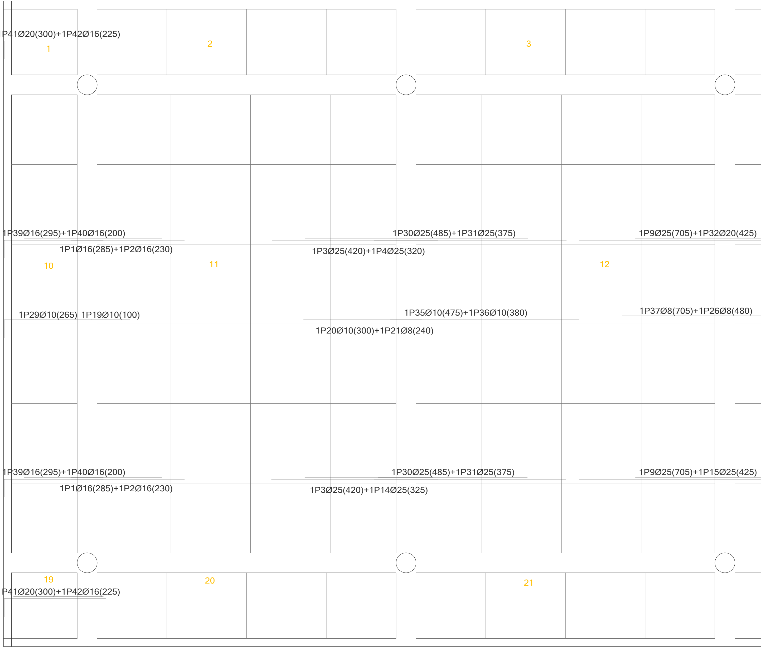
DETALLE ARMADURA FORJADO TECHO P BAJA (ARMADURA LONGITUDINAL SUPERIOR)
