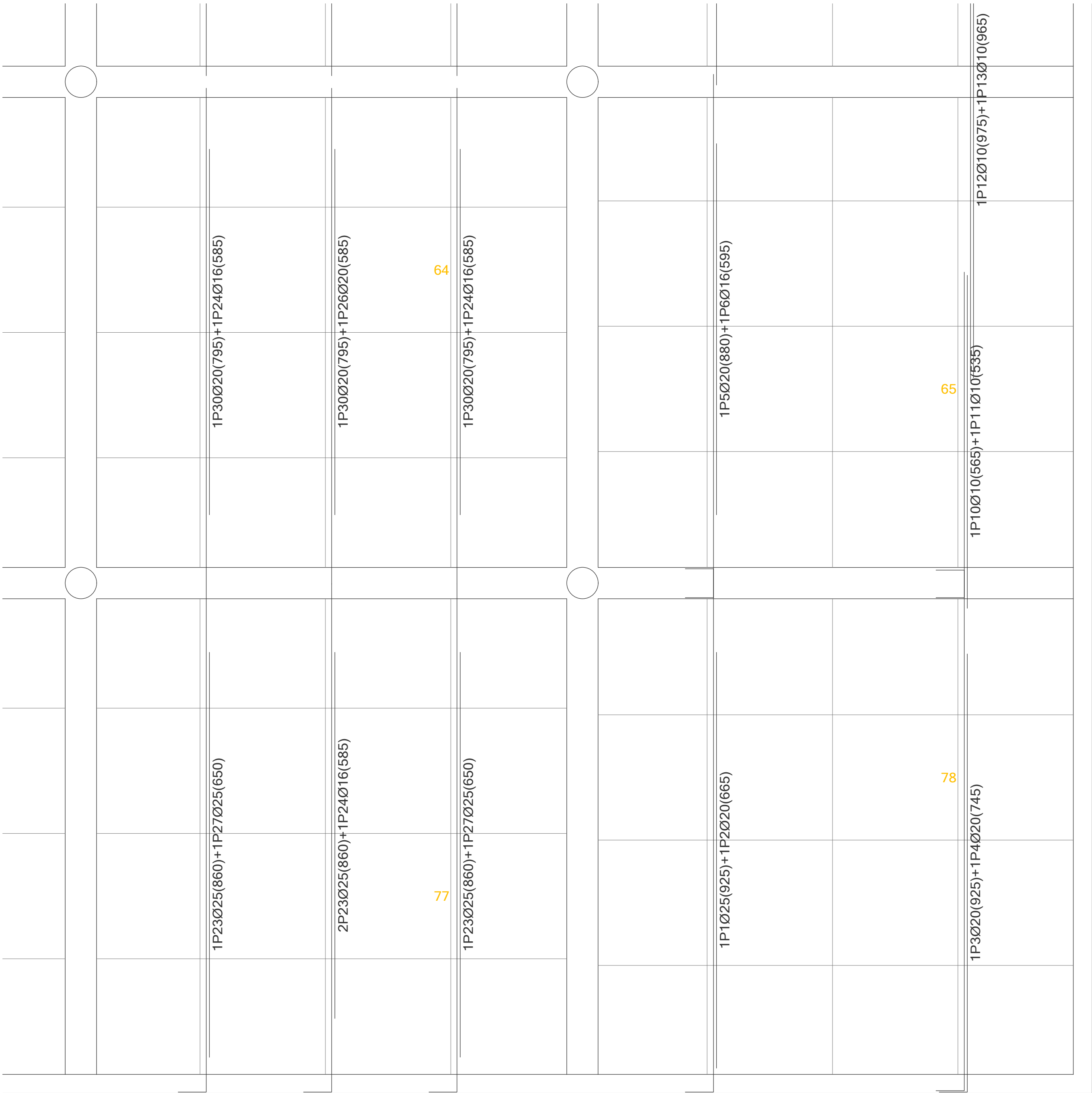
DETALLE ARMADURA FORJADO TECHO P PRIMERA (ARMADURA TRANSVERSAL INFERIOR)
