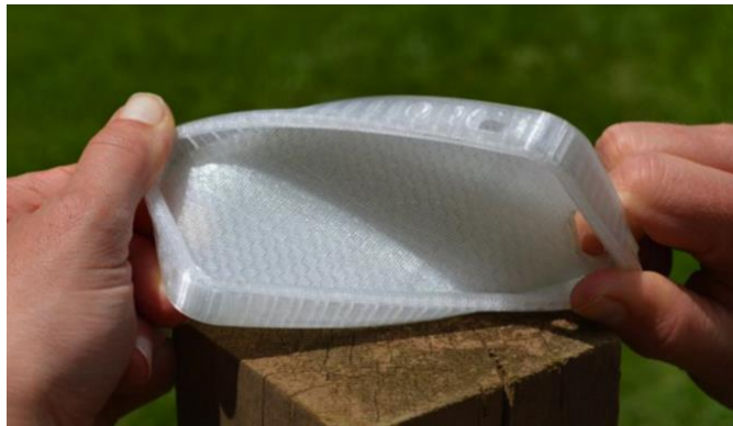
Figura 11. Carcasa de móvil impresa con TPU
