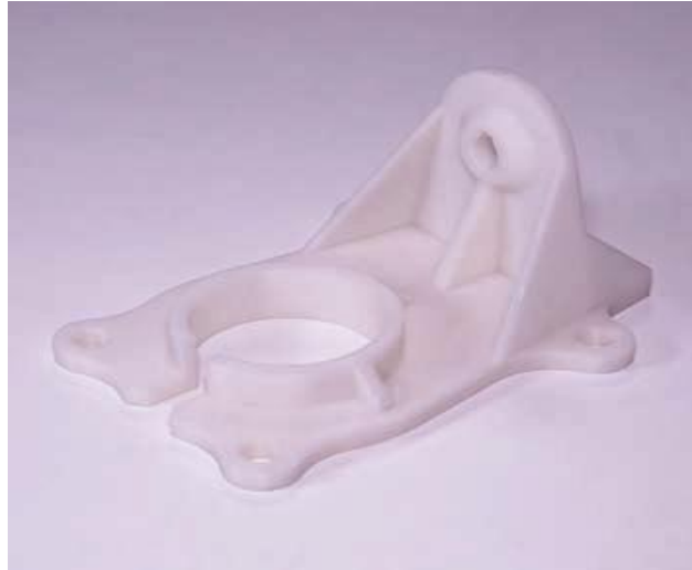
Figura 8. Pieza de ABS procesada por una impresora FDM.
