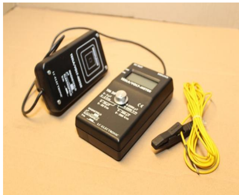
Figura 17. TM-200 con su sensor y el cable de tierra. [Imagen tomada durante la explicación a los alumnos sobre su funcionamiento].
