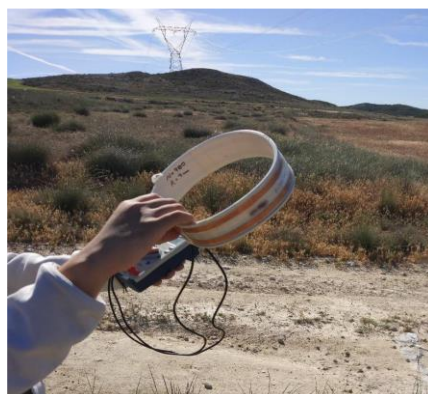
Figura 20. Medidas realizadas con la pandereta cerca del apoyo de la línea. [Fotografía recogida durante la actividad].
