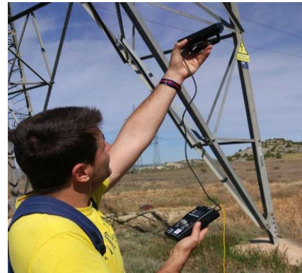
Figura 18. Alumno realizando medidas de campo eléctrico cerca del apoyo. [Fotografía realizada por Carlos Felipe Cabré, compañero de la asignatura Líneas Eléctricas ].
