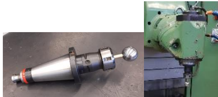
Figura 76: Bola de acero colocada en el portaherramientas y en el cabezal.
