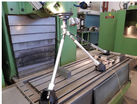
Figura 60: Colocación de los tres brazos dentro de la bancada.
