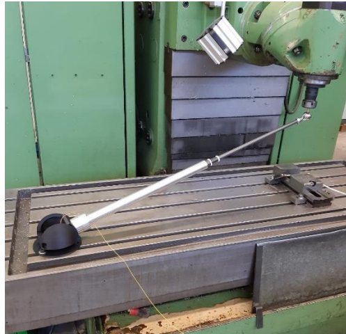
Figura 53: Colocación del brazo para el ensayo.
