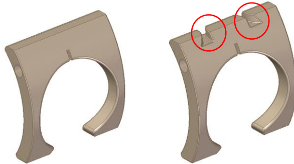
Figura 50: Diseño de la ranura guía.
