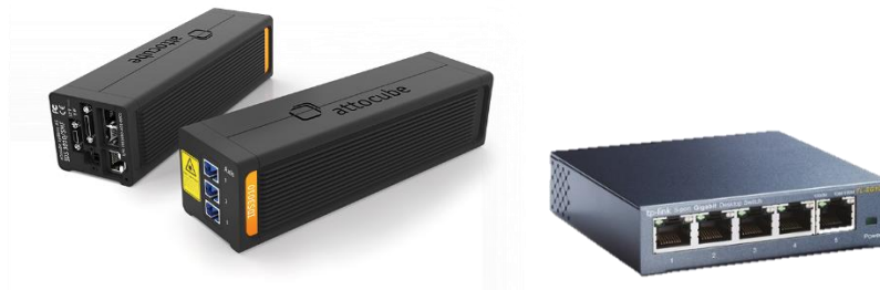
Figura 2: Interferómetro IDS3010 de attocube (izquierda) y Switch TL-SG105 de la marca tp-link (derecha)
