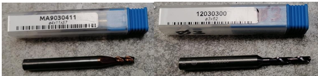
Figura 116: Fresa de 3 labios con corte al centro 4 \phi y broca de 3 \phi .
