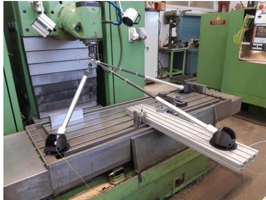
Figura 62: Colocación de dos brazos dentro de la bancada y uno fuera.
