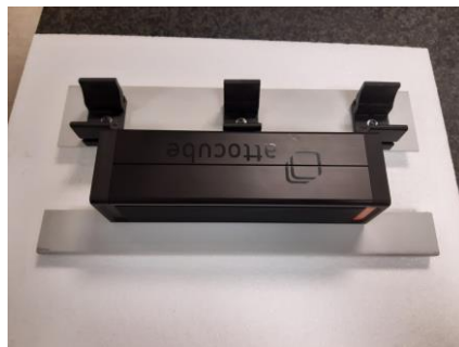
Figura 25: Interferómetro montado en la tapa.
