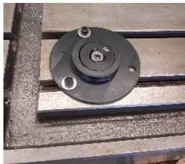
Figura 77: Base anclada colocada en la bancada
