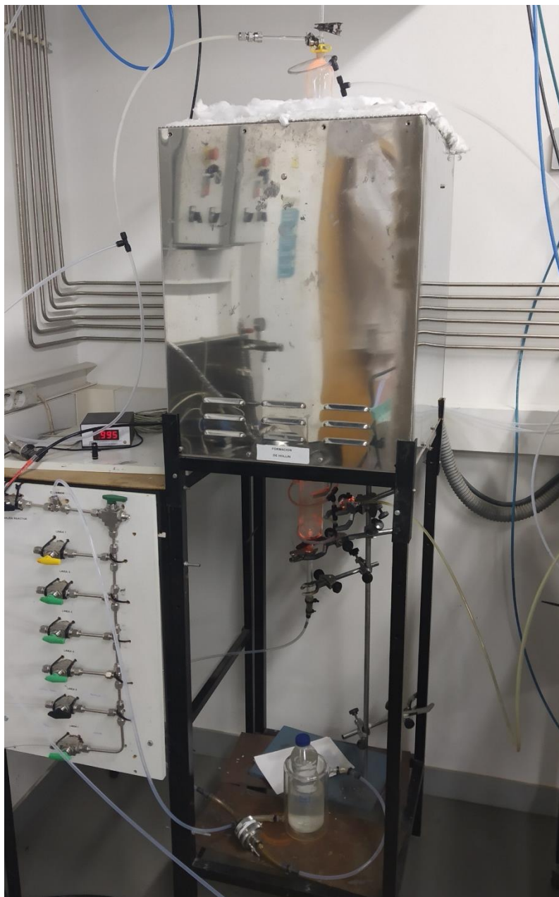
Figura 22. Horno en donde se aloja el reactor (centro), panel de válvulas (izq), condensador y filtro (abajo).
