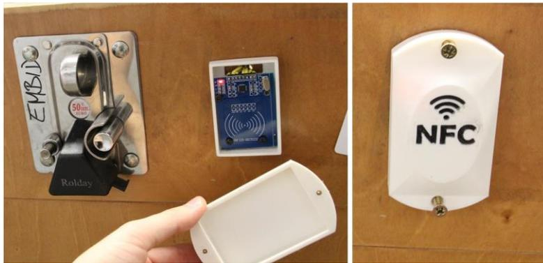
Ilustración 13. Sensor lector de tarjeta sin tapa y con tapa
