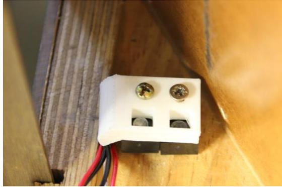
Ilustración 7. Emisor y receptor con pieza de protección
