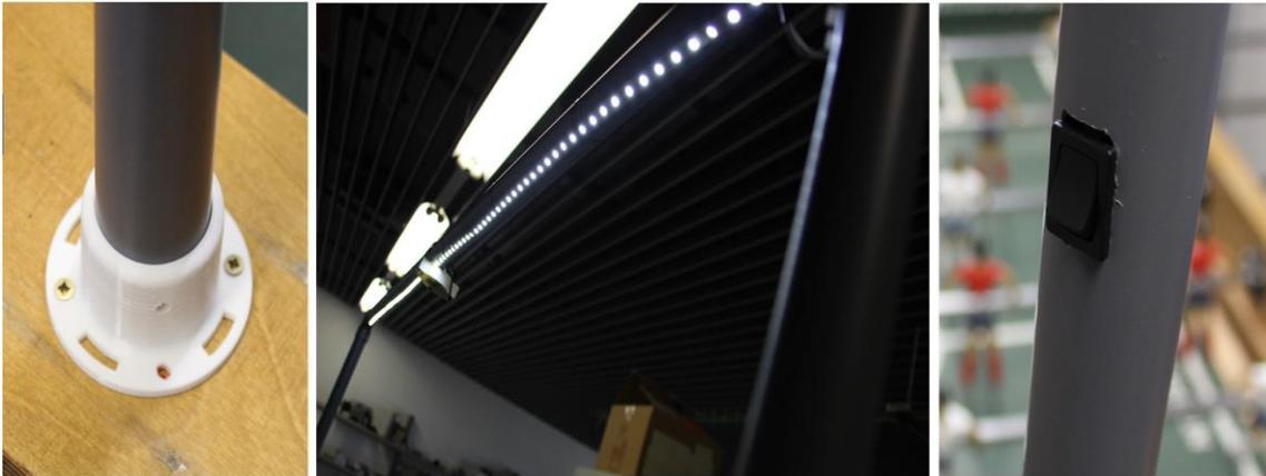
Ilustración 14. A la izquierda pieza de fijación, en el centro tira de leds, a la derecha interruptor
