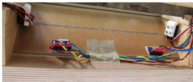
Ilustración 9. Pared de impacto con sus 2 módulos MPU 92/65
