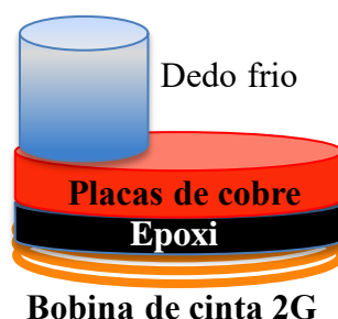
Fig.1.2. Foto de la parte del criorefrigerador donde se alojan las bobinas SAT y esquema de la colocación de la bobina de cinta 2G de Y123 dentro del crio-refrigerador para su caracterización eléctrica. Por simplicidad no se incluyen los contactos e instalación eléctrica, así como los sensores de temperaturas.
