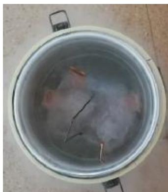
Fig. 3.2. Probetas sometidas en nitrógeno líquido.
