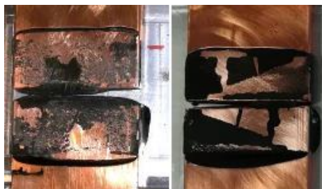
Fig. 3.3. Superficies de rotura de una probeta sin ciclado (izq.) y otra con ciclado térmico (dcha.)
