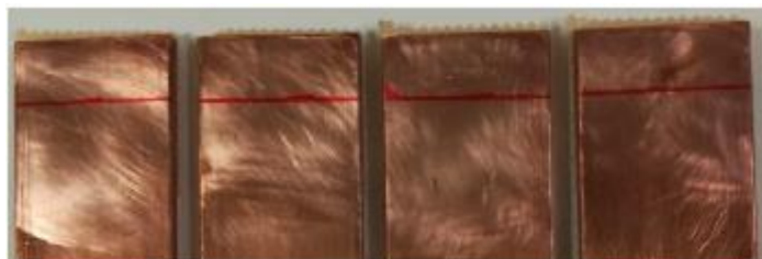
Fig. 3.1. Probetas de cobre pulidas con lija de 1200
