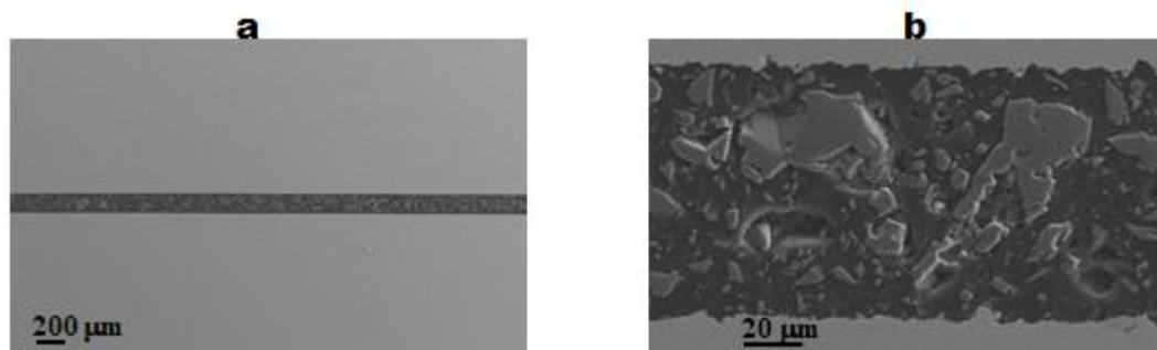
Fig. 3.16. Imágenes FESEM de una unión Cu/epoxi/Cu de una probeta tratada con 61% de potencia del láser: (a) vista general y (b) zona ampliada.
