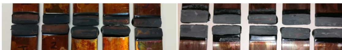
Fig. 3.7. Imagen fotográfica de la sección de fractura de probetas oxidadas durante 3 (a) y 5 minutos (b).
