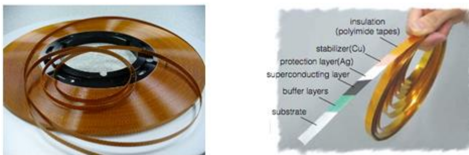
Fig. 1.1. (a) Carrete de cinta 2G de Y123 de 4 mm de ancho envuelto con aislamiento de poliamida (publicado en las actas de la conferencia del IEEE 2009. SuperPower's YBCO Coated High-Temperature Superconducting (HTS) Wire and Magnet Applications . D. Hazelton, V. Selvamanickam). (b) Estructura y composición de una cinta 2G de Y123 fabricada por la empresa japonesa Fujikura Ltd (publicado en Fujikura Technical Review , 2013. Yasuhiro Iijima).
