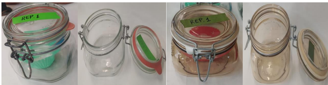
Figura 4. Botes herméticos para ensayos de migración (con los dos tipos de juntas empleadas).
