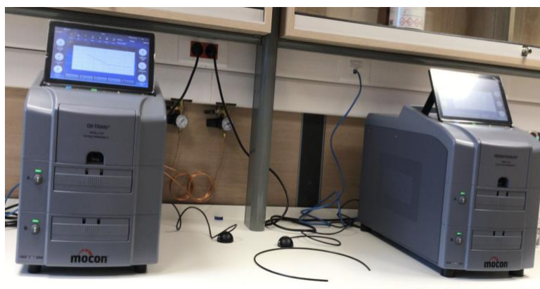
Figura 1. Equipos con los que se caracterizó las propiedades barrera del PLA (OX-TRAN y PERMATRAN).
