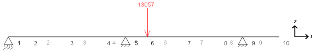
Figura 23. Esquema de cargas en el plano XZ para el eje secundario con la primera velocidad engranada.
