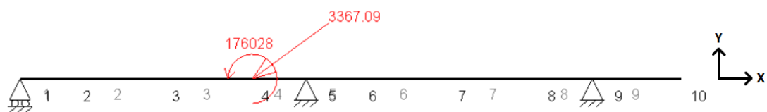
Figura 80. Esquema de cargas en el plano XY para el eje secundario con la sexta velocidad engranada.
