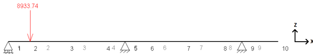
Figura 52. Esquema de cargas en el plano XZ para el eje secundario con la segunda velocidad engranada.
