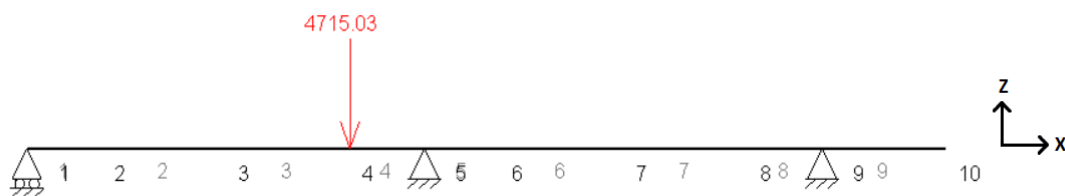
Figura 84. Esquema de cargas en el plano XZ para el eje secundario con la sexta velocidad engranada.
