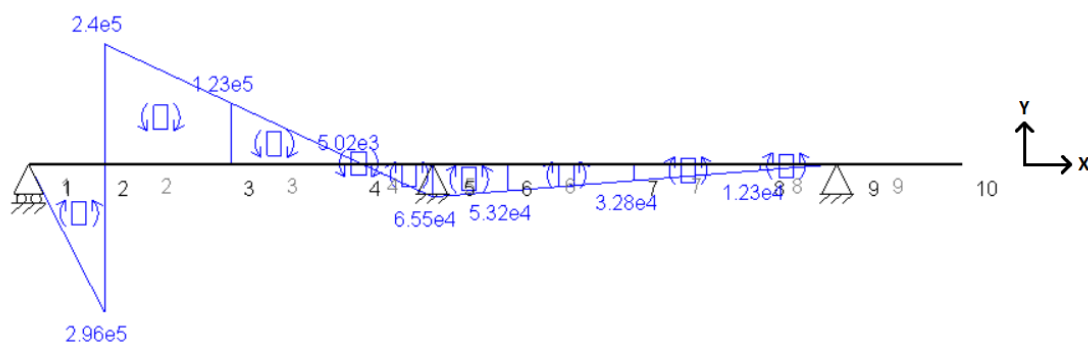
Figura 51. Diagrama de momentos flectores en plano XY para el eje secundario con la segunda velocidad engranada.
