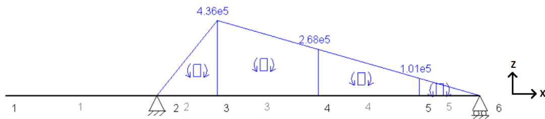
Figura 95. Diagrama de momentos flectores en plano XZ para el eje primario exterior con la segunda velocidad engranada.
