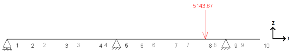
Figura 76. Esquema de cargas en el plano XZ para el eje secundario con la quinta velocidad engranada.
