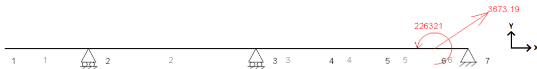
Figura 130. Esquema de cargas en el plano XY para el eje primario interior con la quinta velocidad engranada.
