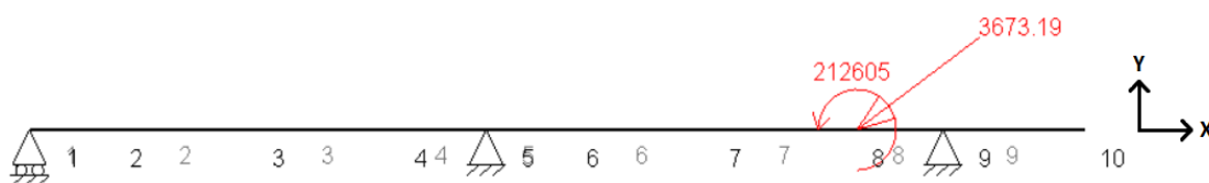
Figura 72. Esquema de cargas en el plano XY para el eje secundario con la quinta velocidad engranada.
