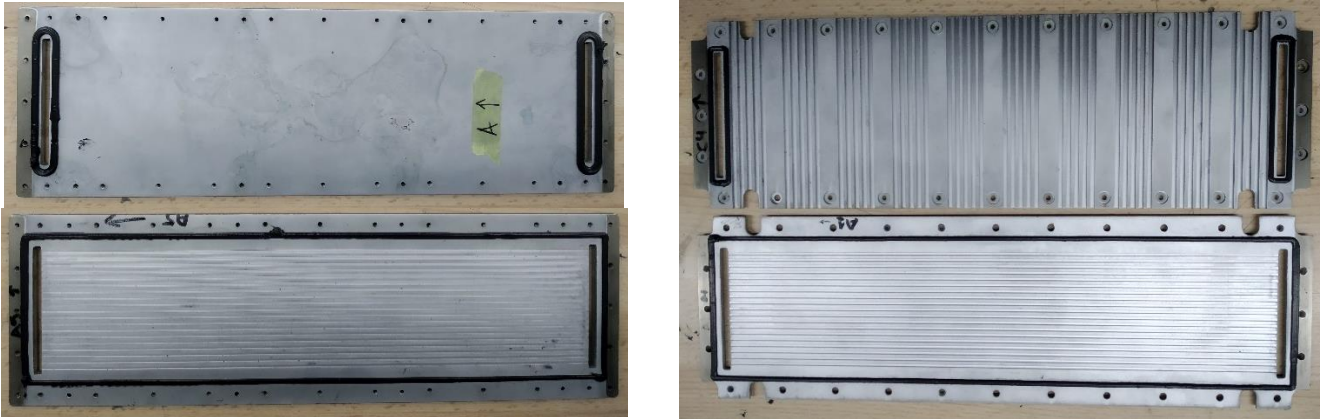
Figura 5.4. Fotos de una placa monopolar (izquierda) con lado ánodo y de una placa bipolar (derecha) por sus dos caras.
