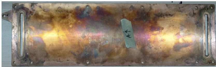
Figura 5.3. Foto del colector de corriente del prototipo de 5 celdas tras su uso.
