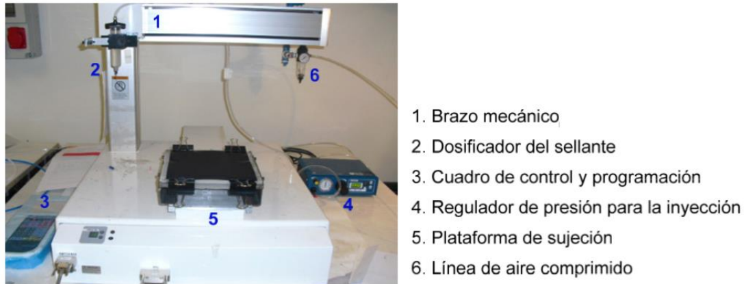
Figura 5.5. Fotografía del robot I&J 2500N-CE220SET de la firma I&J Fisnar.
