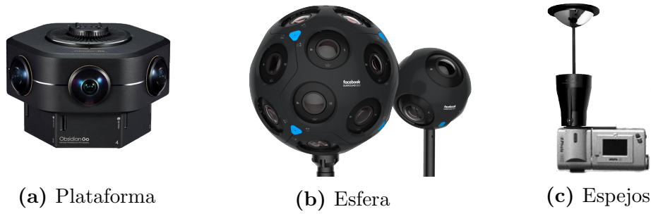
Figura 1.1: Diferentes tipos de cámaras omnidireccionales. La (a) consiste en una plataforma con 2 o más cámaras repartidas uniformemente en 360^\circ , mientras que en el dispositivo (b) las cámaras son repartidas uniformemente alrededor de una esfera. La (c) es una cámara convencional con una "lente" de espejo omnidireccional.
