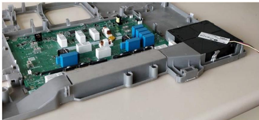
Figura 1. Sistema de refrigeración de la cocina de inducción.
