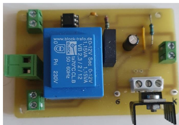
Figura 4.1-2. Placa circuito de potencia.
