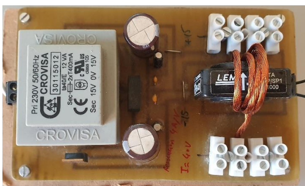
Figura 5.1-1 Transformador de corriente.
