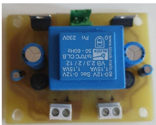
Figura 4.1-1. Placa Fuente de alimentación doble.
