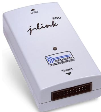
Figura 3.2: Sonda de depuración externa J-Link EDU.
