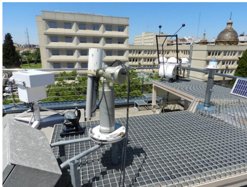
Figura 15. Fotómetro solar CIMEL CE318 situado en la sede de AEMET en Zaragoza.
