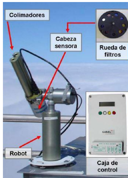
Figura 16. Principales componentes de un fotómetro solar CIMEL CE318. Fuente: Guirado (2015).
