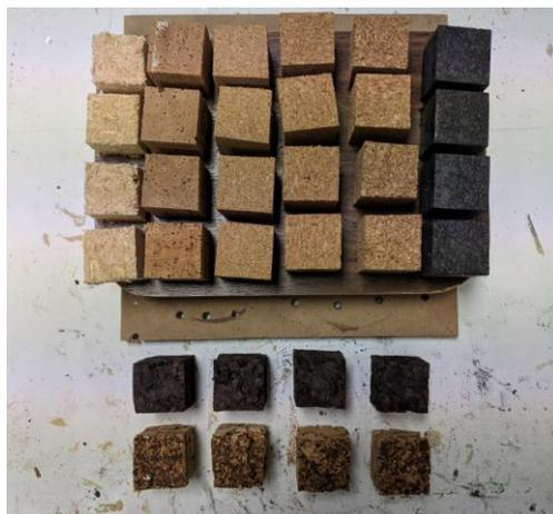
*Figura 11, 28 probetas preparadas para realizar los ensayos de compresión.*
