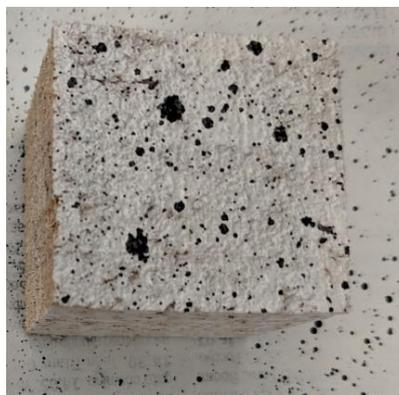
*Figura 14. Patrón estocástico pintado en la superficie de una de las probetas.*
