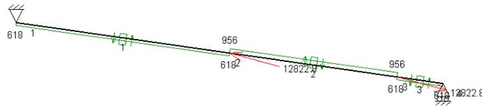
Ilustración 130: Diagrama de esfuerzos cortantes
