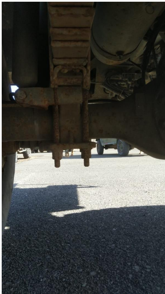
IMAGEN 15 CORROSIÓN EN LOS ABARCONES DE AMORTIGUACIÓN
