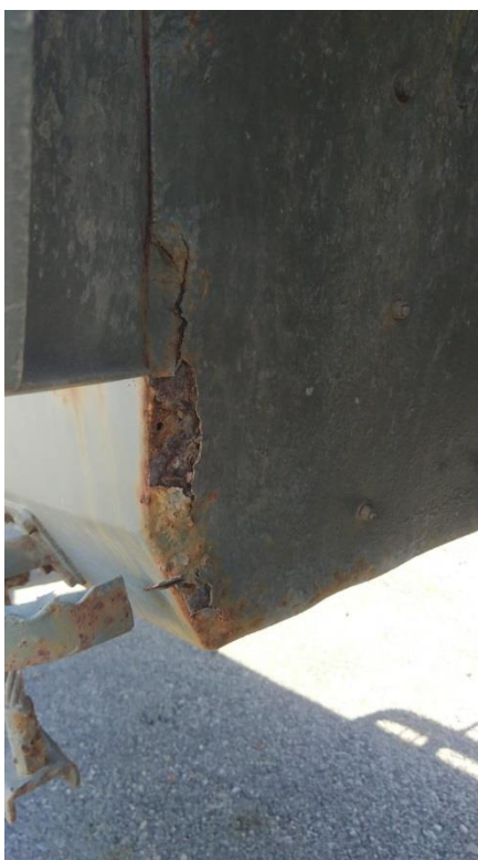
IMAGEN 7 EFECTO DE LA CORROSIÓN EN LA CARROCERÍA DEL VEHÍCULO RG-31. ELABORACIÓN PROPIA
