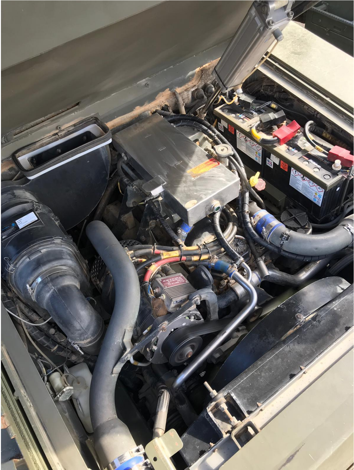
IMAGEN 18 AUSENCIA DE CORROSIÓN EN LA CÁMARA DEL MOTOR
