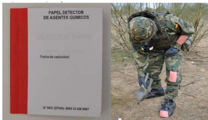
Figura 29. Librillo de papel detector y ejemplo de uso
