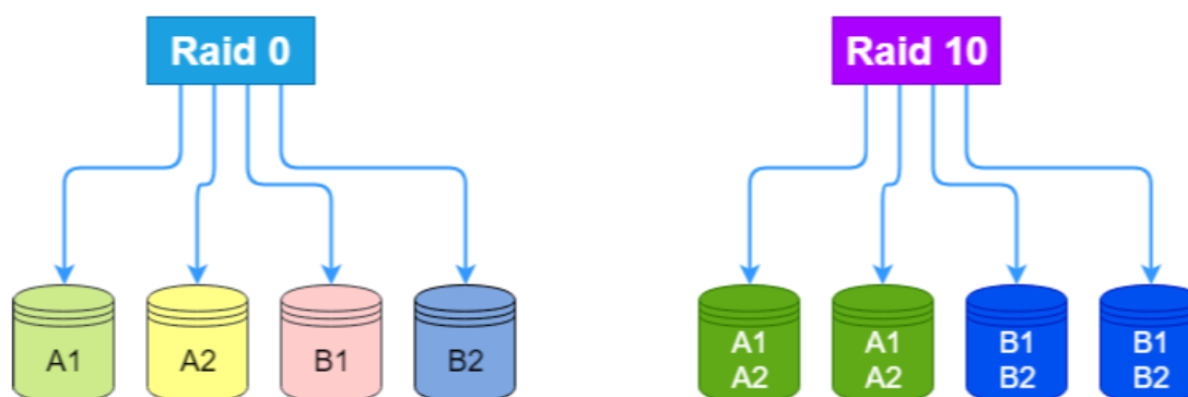
Ilustración 9: Esquema de almacenamiento RAID 0 y RAID 10. Fuente: Elaboración propia.
