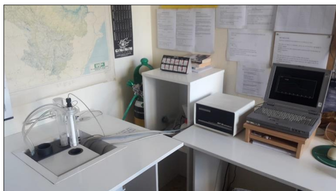
Figura 5. Susceptómetro KappaBridge KLY-3S acoplado a un horno CS3 bajo una atmósfera de Argón, de Universidad de Zaragoza.
