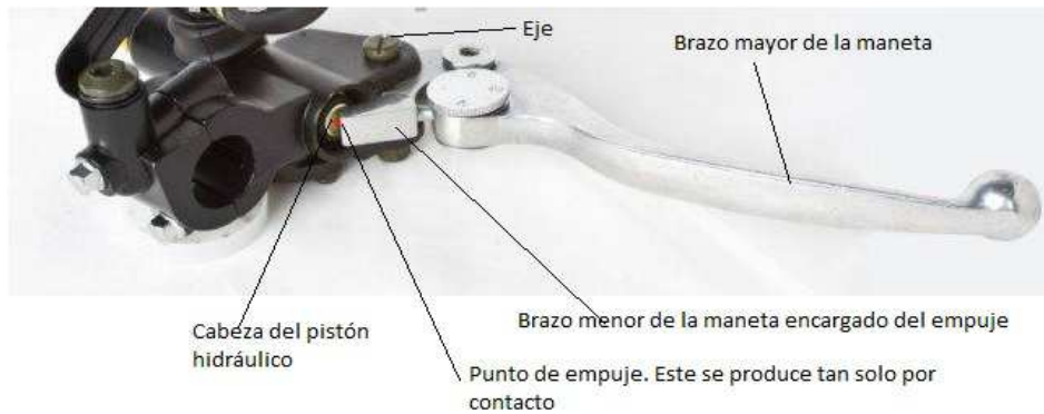
Figura 18. Maneta convencional y su interacción con la bomba de freno.
