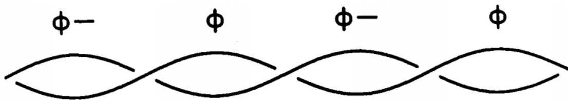
Figura 3.6: El twisted pair reduce el ruido magnético en señales diferenciales, puesto que el flujo magnético a través de cada vuelta se compensa con un flujo magnético opuesto en la siguiente. El flujo total a través del par es (idealmente) nulo, luego la diferencia de voltaje permanece inalterada (Smith E.N. y Richardson R.C., 1988).
