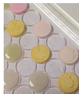
Figura 4.16 Detalle de la placa. Celulosa descorchada.
