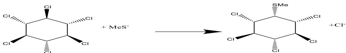
Figura 12. Reacción S_N2 de beta-HCH con ion metanotiolato.
