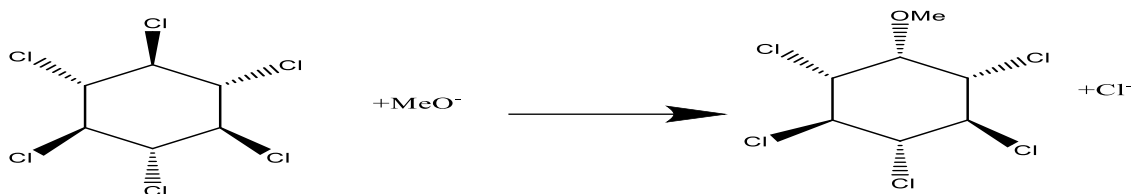
Figura 8. Reacción S_N2 de beta-HCH con ion metóxido.
