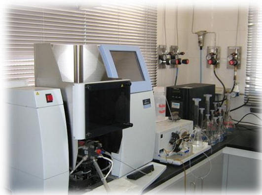
Figura I. Espectrómetro de absorción atómica de llama (Perkin Elmer Analyst 200).
