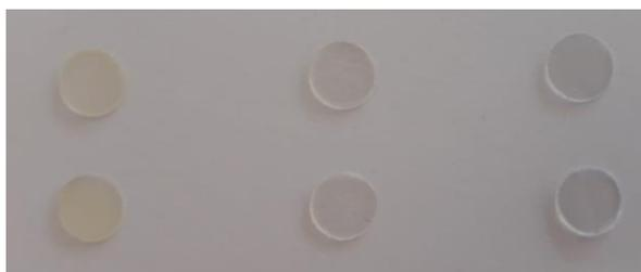
**Figura 6:** Láminas de PLA con diferentes concentraciones de oro inmovilizado. De izquierda a derecha:  $3 \cdot 10^{-3} \text{M Au}$ ,  $1,5 \cdot 10^{-3} \text{M Au}$ , PLA sin oro inmovilizado.
