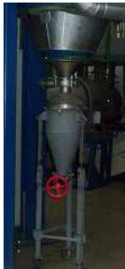
Fig. 42 Adaptación de la recogida de cenizas de la cámara de combustión [90].
