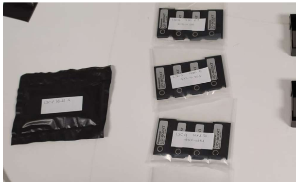
Figura 3.1: Dosímetros en su envase herméticamente cerrado con su correspondiente etiquetado (izquierda) y conjuntos de dosímetros antes de envasarlos con su correspondiente etiquetado (derecha).
