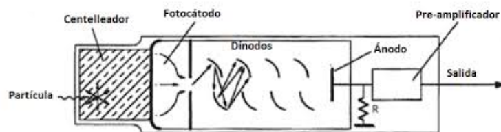
Figura 4: Detector de centelleo [14]
