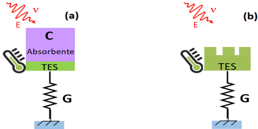
Figura 1: Visualización esquemática de la estructura, a grandes rasgos, de dos TES diseñados para distintas aplicaciones: rayos X (izquierda), infrarrojo (derecha). La G es la conductancia del TES al baño térmico a temperatura constante. (a) Esquema de un TES sensible a los rayos X. La radiación incide en el absorbente de rayos X, haciendo el TES sensible a dicha radiación. (b) Esquema de cómo se espera que podría ser un TES sensible a la radiación infrarroja. La radiación incide sobre la nanoestructura metálica de ranuras que permite una alta absorción en este rango.
