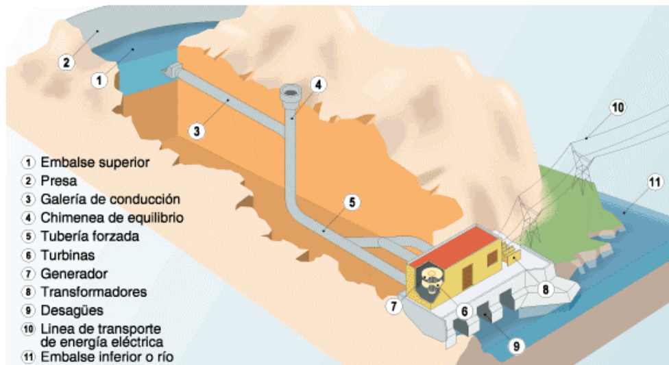
Figura 1. Esquema de una central de Bombeo Reversible [5].
