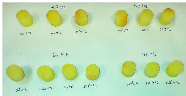
Figura 8.12. Imagen de los cilindros de patata tras diferentes tratamientos de PEAV de 5 kV/cm y 10 s de duración a distintas frecuencias.
