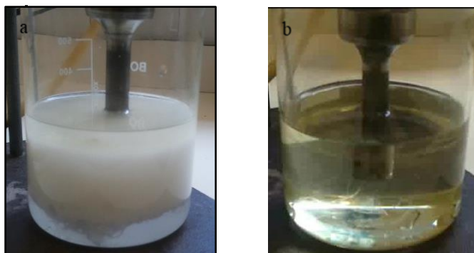
Figura 7.7. Preparación de una emulsión de agua en aceite mediante el cuerno de ultrasonidos(a) y la aplicación de ultrasonidos sobre aceite (b).
