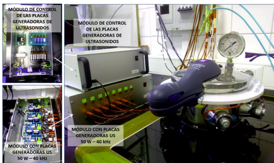
Figura 3.49. Imagen de la U-Pot IV, el módulo intermedio de activación de las placas generadoras de ultrasonidos y los transductores.
