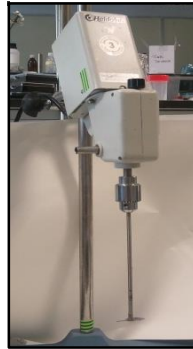
Figura 7.4. Agitador de paletas (modelo RZR1, Geildolph Instruments, Schwabach, Alemania)
