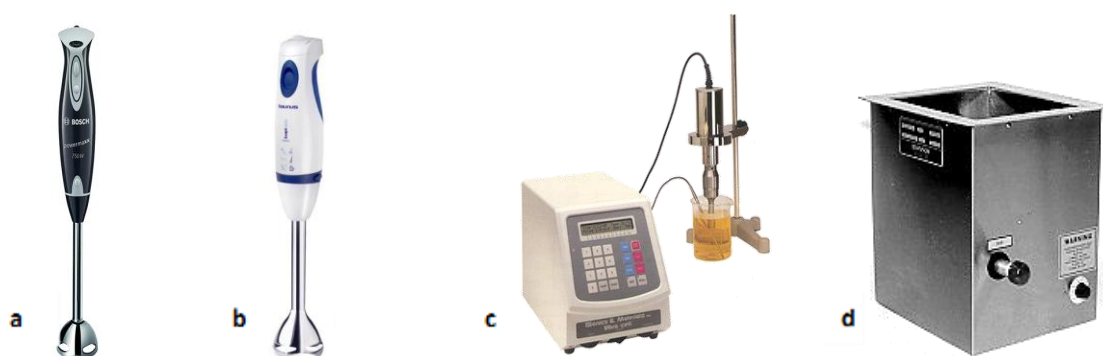
Figura 7.3. Batidora (BOSH Powermaxx 750W) (A); batidora (Taurus Bapi 600W) (B); cuerno de sonicaci n 450 W (Branson) (C), ba o de ultrasonidos (ELMA 35-130 kHz, 4x35W) (D).
