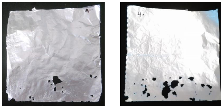
Figura 3.42. Fotografías de los trozos de papel de aluminio tratados por ultrasonidos en agua a 20-24°C (izquierda) y 4°C (derecha) con la U-Pot I durante 5 minutos. Extraído de Sainz (2016).
