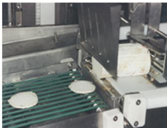
Figura 1.34. Corte asistido con ultrasonidos de un producto de pastelería (Chemat et al. , 2011).
