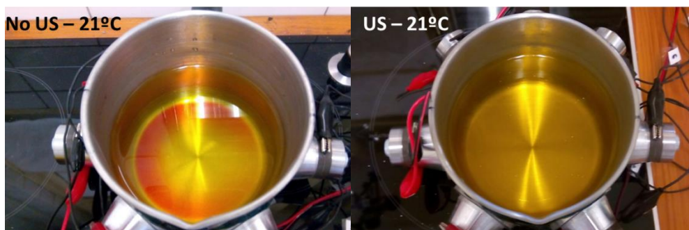
Figura 3.44. Aspecto de la disolución de tartracina adicionada a agua a 21°C sin (izquierda) y con aplicación de ultrasonidos (derecha) en el prototipo U-Pot III.
