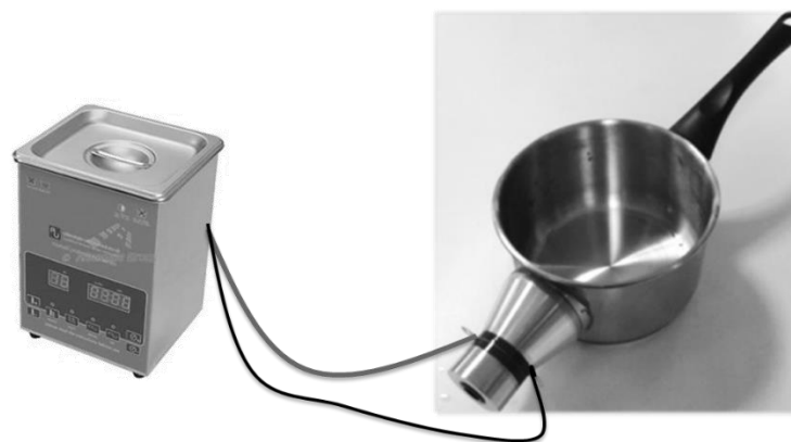
Figura 3.15. Primer prototipo de recipiente (U-Pot I) que permite la aplicación de ultrasonidos (40 kHz/50 W) para el cocinado de alimentos sobre una placa de inducción u otro sistema de calentamiento (fogón, placa vitrocerámica).
