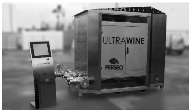
Figura 1.31. Equipo Ultrawine desarrollado por la empresa Agrovín (España) aplicado para acelerar la etapa de maceración en la obtención de vinos tintos.
