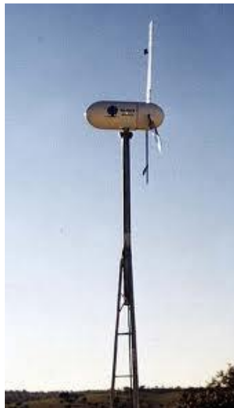
Figura 2.6. Aerogenerador con configuración sotavento.
