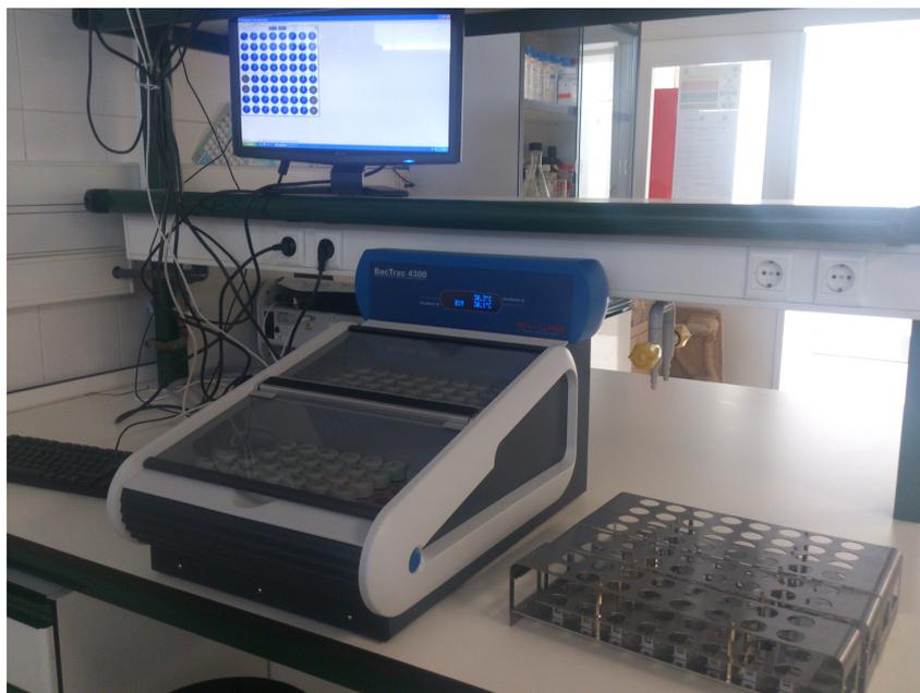
**Figura 16.** Equipo de impedanciometría BacTrac 4300.
