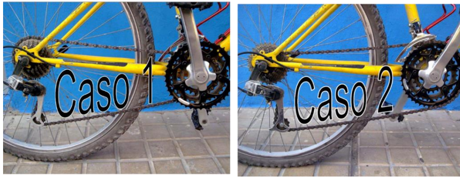
Figura 8: distintos desarrollos en el sistema de transmisión de una bicicleta (La Ciclería, s.f.)
