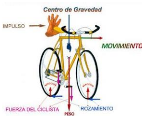
Figura 5: fuerzas que actúan sobre una bicicleta (Anónimo, 2015)
