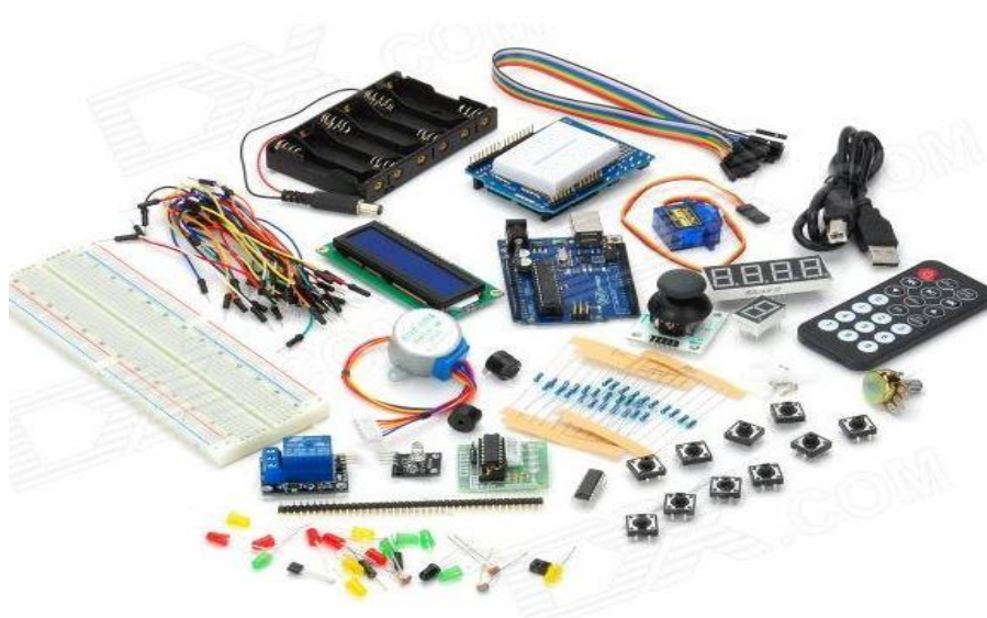
Imagen 8: Kit de accesorios, sensores y componentes de Arduino. Fuente: Dosban
