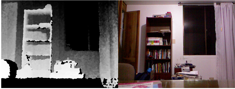
Figura 2.2: Imágenes capturadas por el sensor kinect. En la derecha podemos ver la imagen de la cámara RGB y en la izquierda la imagen captada por el sensor de profundidad.
